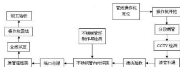
图3 不锈钢内衬施工工艺流程图
